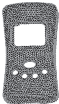
图1 手机前盖有限元模型
